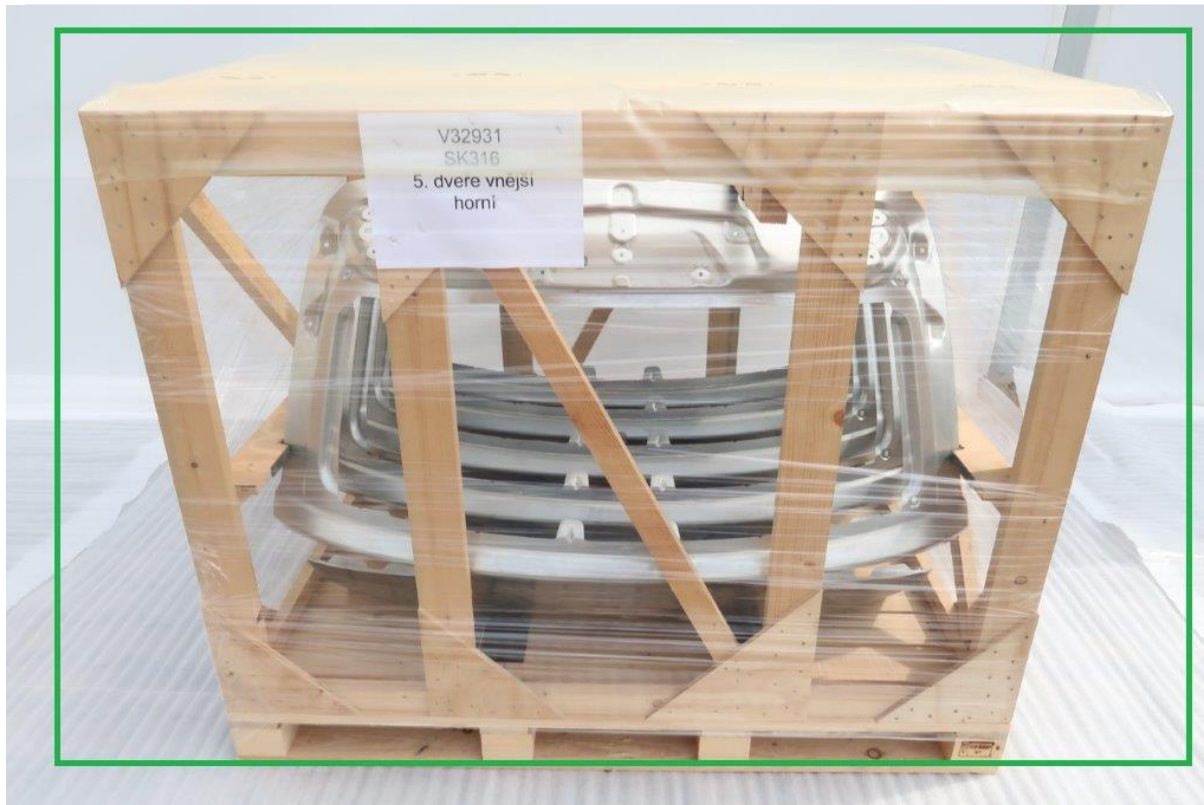
Obr. 2: Obal zabezpečen obalovou folií proti znečištění, navlhnutí atd.
