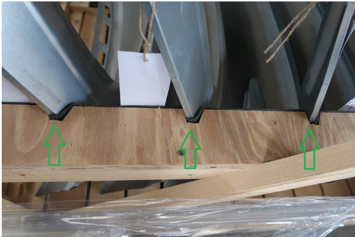
Obr. 4: Fixace dílů na ochranu před poškozením nebo volným pohybem
