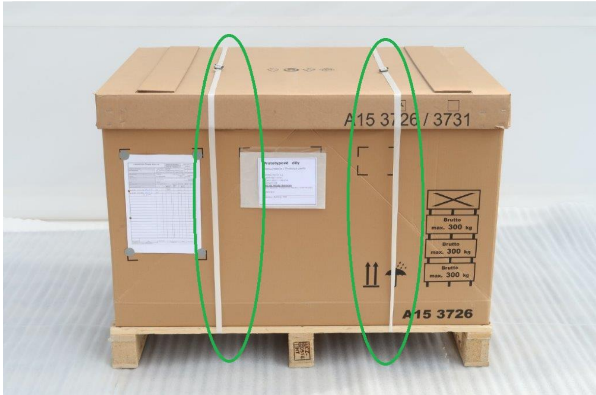
Abb.1: Die Unterpalette und die Verpackung sind mit einem Spannband vor freier Bewegung während des Handlings gesichert.
