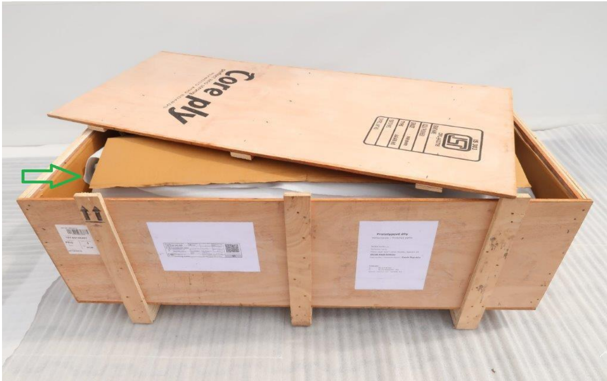
Abb. 3: Art und Weise der Verpackung mit Zwischenlagen zum Schutz vor Beschädigung der Einzelteile.
