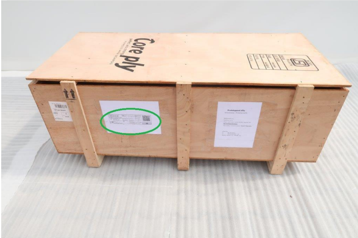
Abb.: 5: Kennzeichnung der Verpackung mit einem Warenanhänger und einem Identifikationsschild
