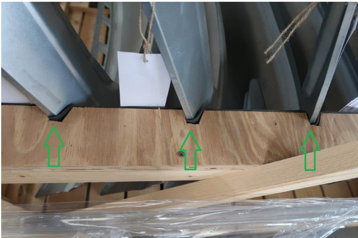
Abb.: 4: Fixation der Teile gegen Beschädigung oder freie Bewegung
