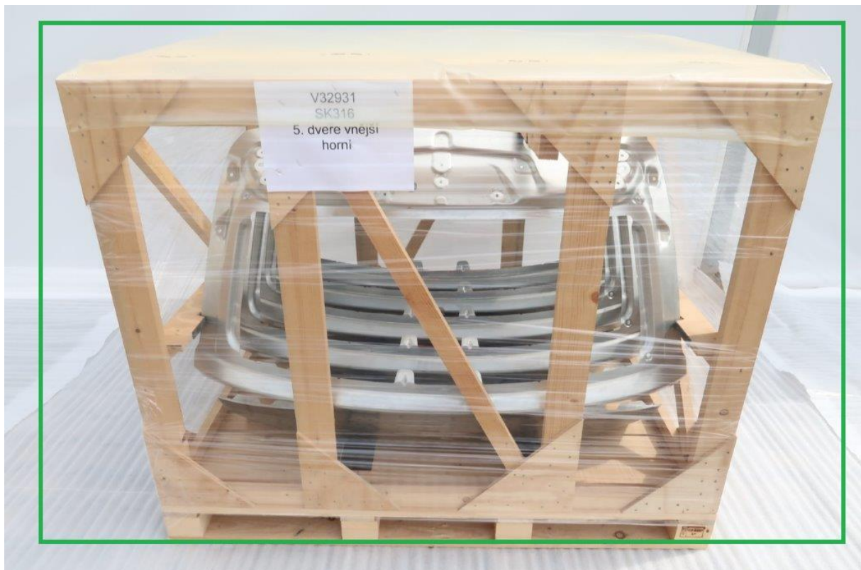
Abb.: 2: Die Verpackung ist durch Packfolie vor Schmutz, Feuchtigkeit usw. gesichert.
